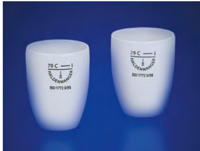
Haldenwanger-Tiegel vor (links) und nach (rechts) der thermischen Behandlung. Der Test belegt die thermische Stabilität der Glasur, auch nach mehrmaligen Anwendungen.
