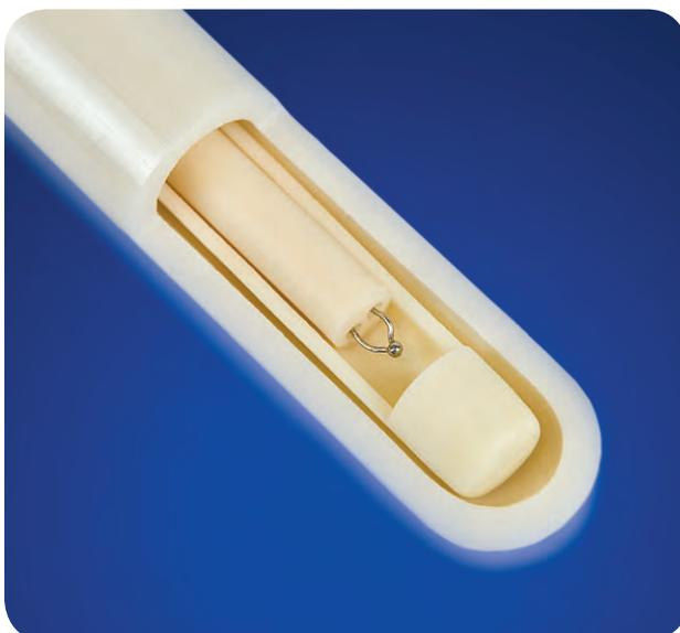
Typischer Aufbau keramischer Schutzrohre zur Temperaturmessung in kohlenstoffhaltigen Atmosphären, wie z. B. zum Einbau in DSS-Öfen für die Photovoltaik- und Siliziumindustrie.
